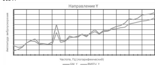
Рисунок 7. Относительные амплитуды виброускорений по оси Y
