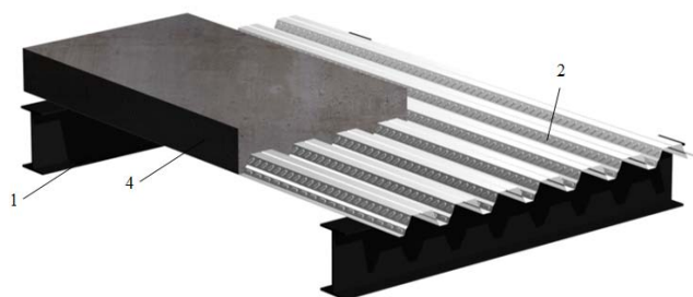
Рисунок 1 – Сталежелезобетонная плита перекрытия 1 – балочная система перекрытия; 2 – несущее основание монолитной плиты перекрытия, выполненное из листов профилированного настила, выполняющего функции: несъемной опалубки (при возведении) и рабочей арматуры (при эксплуатации); 3 – рабочая стержневая арматура сечения плиты — отсутствует; 4 – бетонная смесь.
