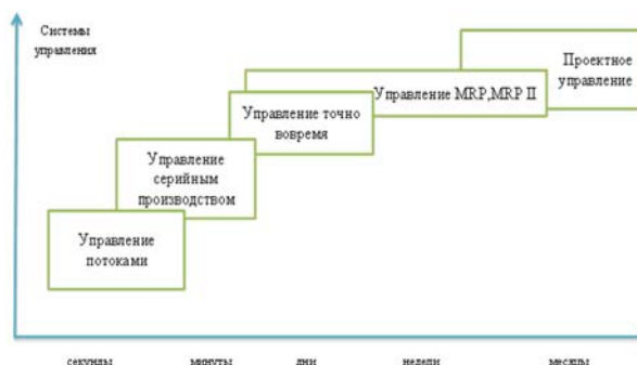
Рисунок 1. Классификация систем производственного управления
