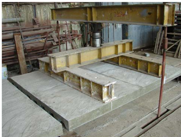
Рисунок 3 – Схема формирования и передачи нагрузки на стенд.
